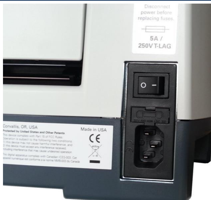
Rysunek 3. Moduł zasilania z tyłu drukarki.
